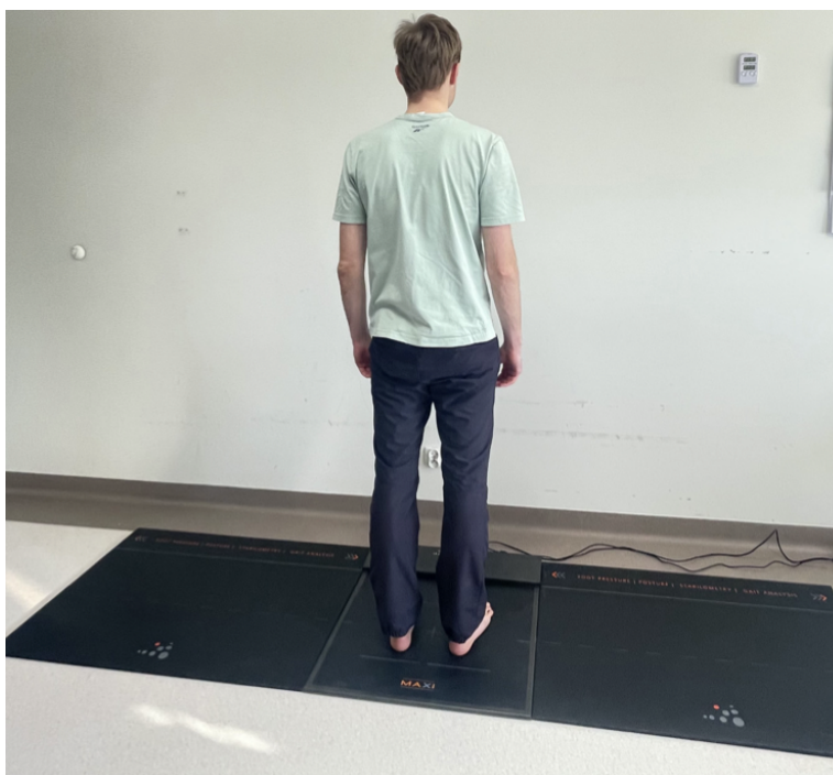
Rycina 4 - Platforma pedobarograficzna FreeMED MAXI (SensorMedica).
